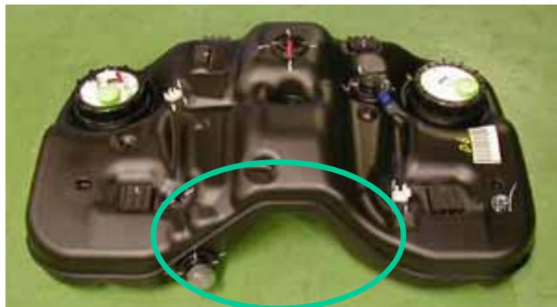
4輪駆動車搭載樹脂製燃料タンク例
