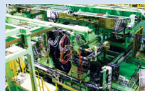
●試験研究用樹脂製燃料タンク成形機(上)と小型ブロー成形機(右)
