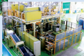
●試験研究用樹脂製燃料タンク成形機(上)と小型ブロー成形機(右)
