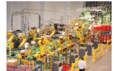
YMAの樹脂製燃料タンク生産ライン
