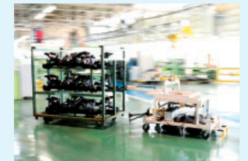
工場内で製品を搬送する自動搬送装置
