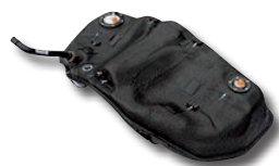
鉄製燃料タンク
