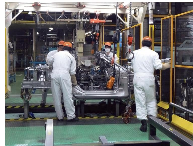
インナー治具工法により実現するスポーツカーとしての高剛性ボディ
