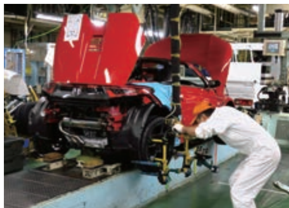
量産ライン上で専用ホイールを取り付ける
