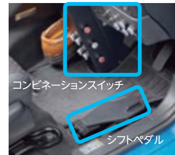
右足では、各スイッチ類やシフトチェンジ用のペダルを操作
