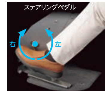
左足ペダルで自転車をごくような動作でステアリング操作
