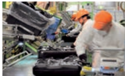
樹脂製燃料タンクを生産する柏原工場の生産ライン
