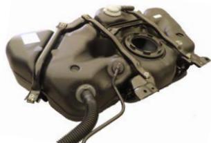
外部補強構造 ⇒ 内部支柱構造
